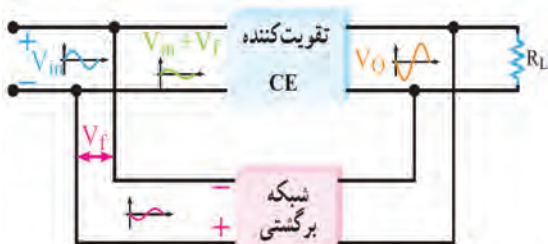
شکل ۱۸-۱۰- بلوک دیاگرام تقویت کننده با فیدبک منفی
