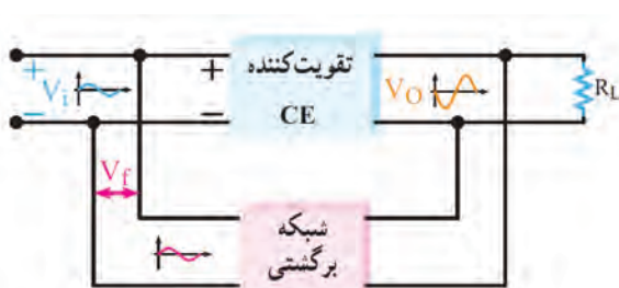
شکل ۱۶-۱۰- بلوک دیاگرام تقویت کننده با فیدبک
