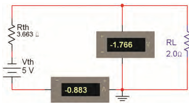
شکل ۸-۱۳- اندازه‌گیری جریان بار در مدار معادل تونن
