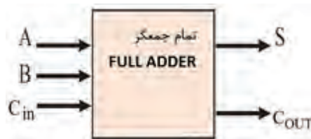
شکل ۹-۶ مدار بلوکی تمام جمع گر
