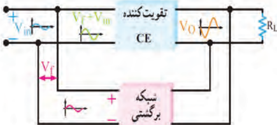
شکل ۱۷-۱۰- بلوک دیاگرام تقویت کننده با فیدبک مثبت
