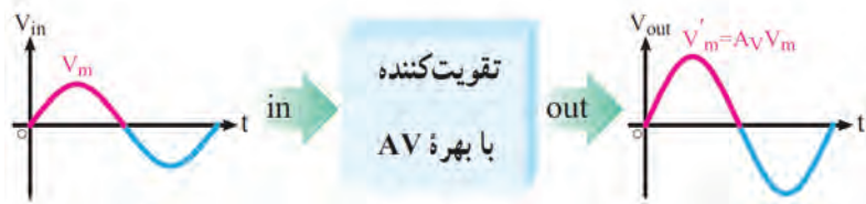
شکل ۱۰-۳۲- مدل بلوکی تقویت کننده
